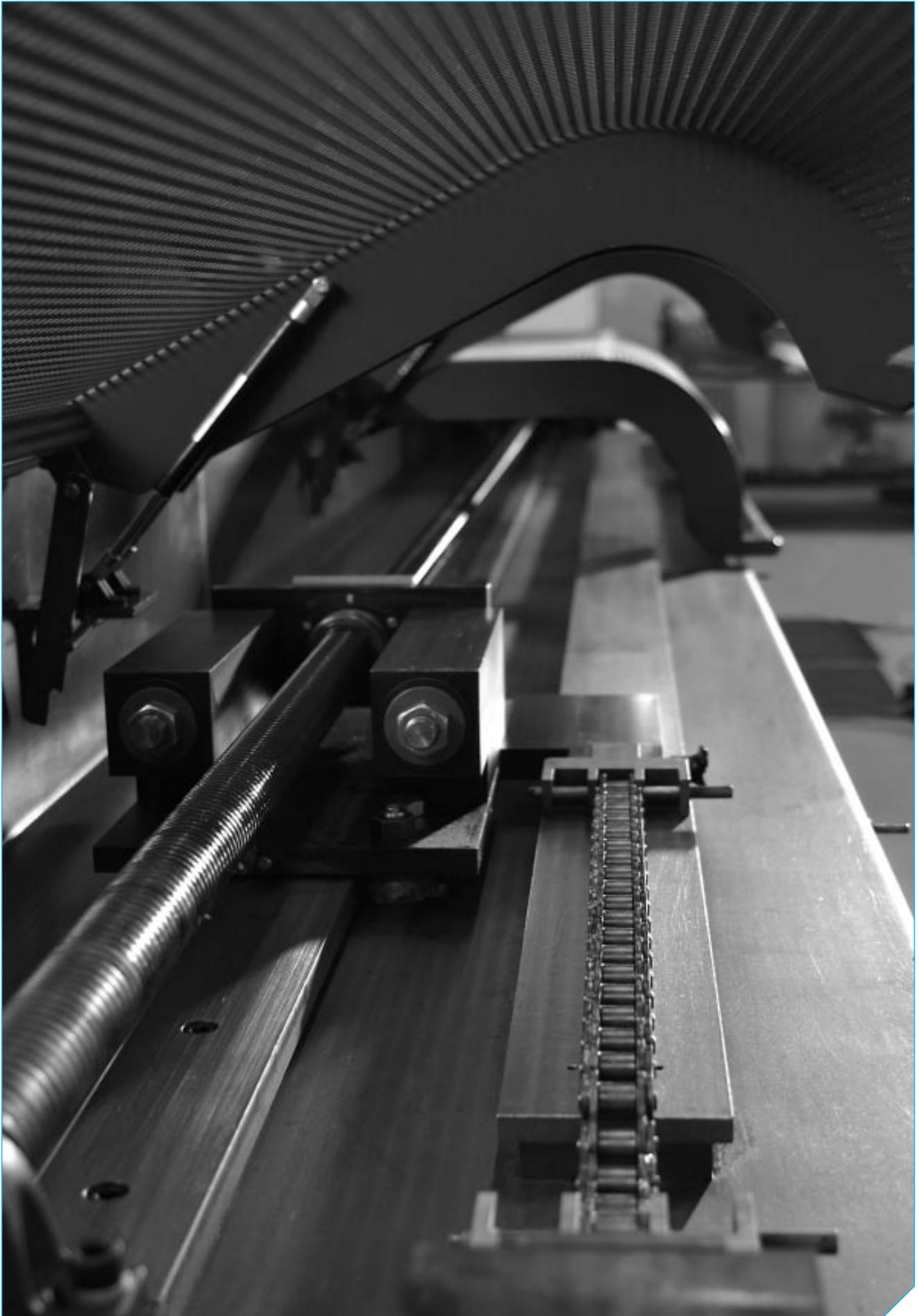
Matchy – Vorrichtung zum paarweisen Vorrecken für Parallellauf
