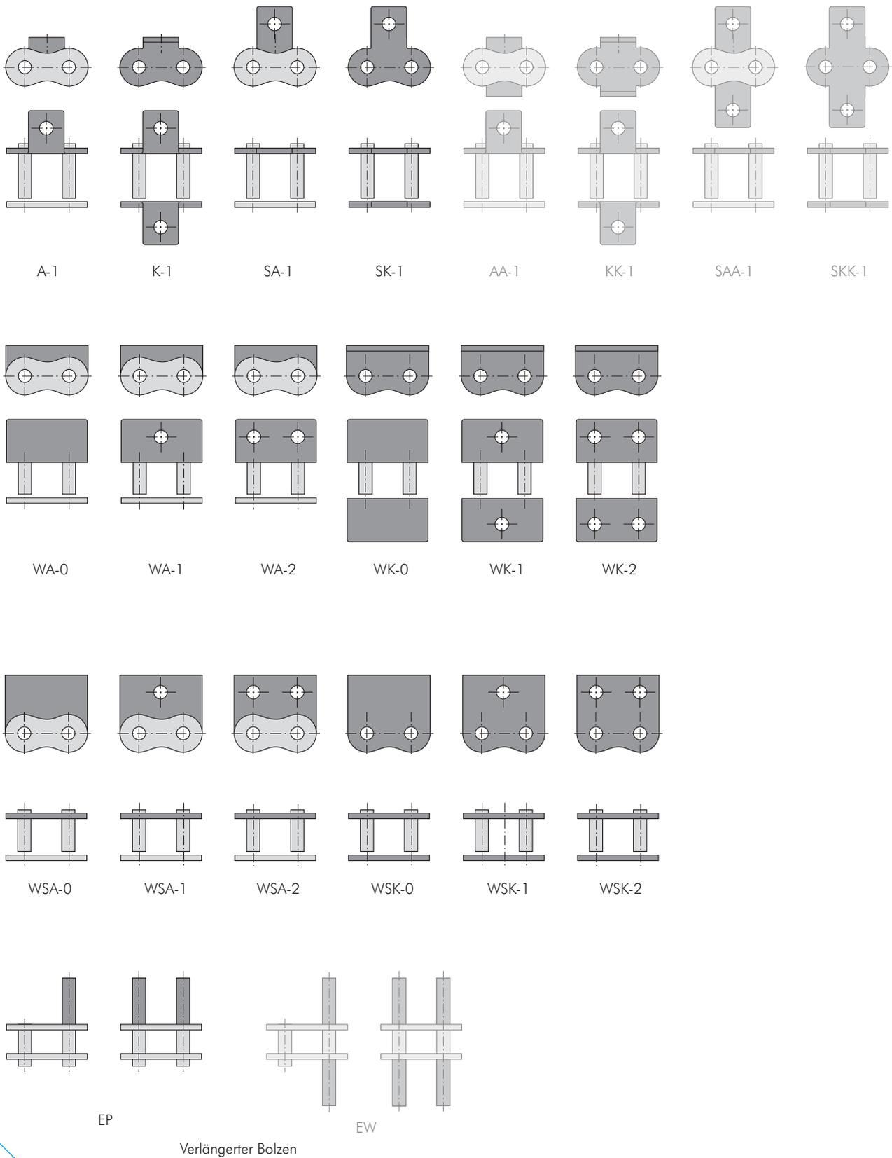
Abb. 3 Typenübersicht kurzgliedrige Ketten mit Anbauteilen
