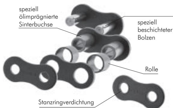
Abb. 22 Grundkonstruktion
