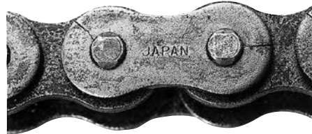
Risse durch Wasserstoffversprödung
