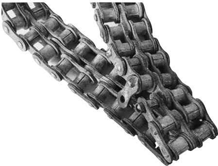
Korrosion einer Rollenkette aus Edelstahl
