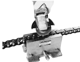
Abschleifen der Bolzenenden
